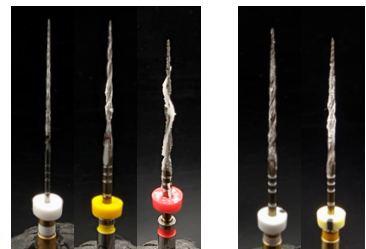
Ryc. 2: Zdjęcie porównawcze pilników po usunięciu resztek w celu przedstawienia różnic w cięciu
