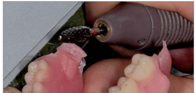
Abb. 2: Die schnittfreundige Verzahnung wird immer dort eingesetzt, wo Kunststoff effektiv abgetragen werden muss, wie etwa bei Presskanälen und groben Überschüssen.
