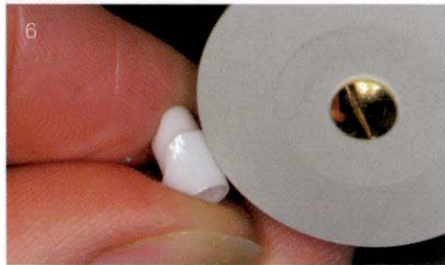
Abb. 6 ... und bringe sie dann mit dem feineren hellgrauen Polierer 94011F auf Hochglanz. Homogene Oberflächen sind hier Pflicht, damit sich keine Plaque anlagert
