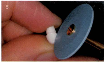
Abb. 5 Die Ränder und subgingivalen Bereiche der harten Zirkon-Abutments poliere ich routinemäßig mit einem blauen Komet Zirkonoxid-Pollerer 94011C vor ...
