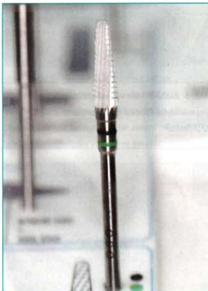
Abb. 10: Ein Keramikfräser mit GSQ-Verzahnung hat einen ausgeprägten Querhieb und bleibt bei richtiger Handhabung dauerhaft scharf.
