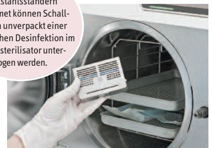
Werden Instrumente in einem Reinigungs- und Desinfektionsgerät (RDG) aufbereitet, ist darauf zu achten, dass die Edelstahländer gelegt werden, damit kein Spülschatten entsteht.
