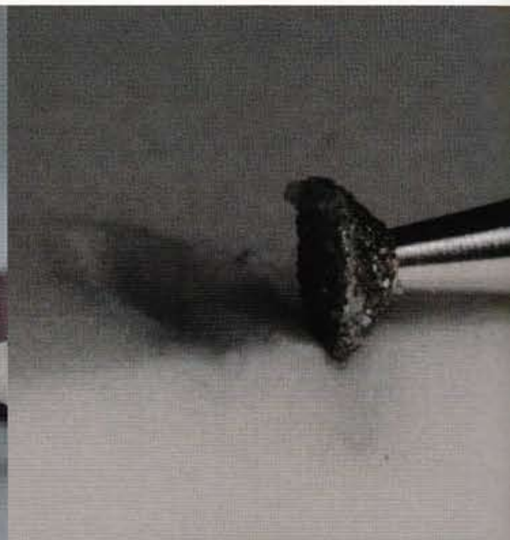
25 Säubern des Diamanten mit dem zuvor gewässerten Reinigungsstein
