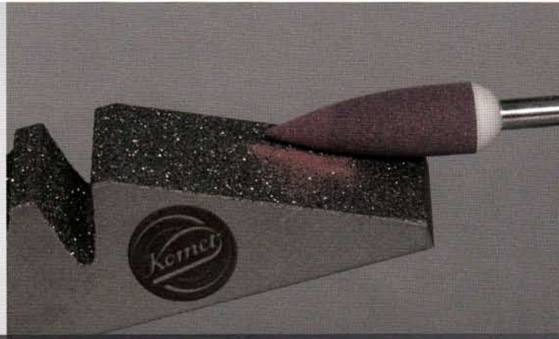
19 Anspitzen des „roten“ Keramikpolierers (medium) am Abriebblock 993
