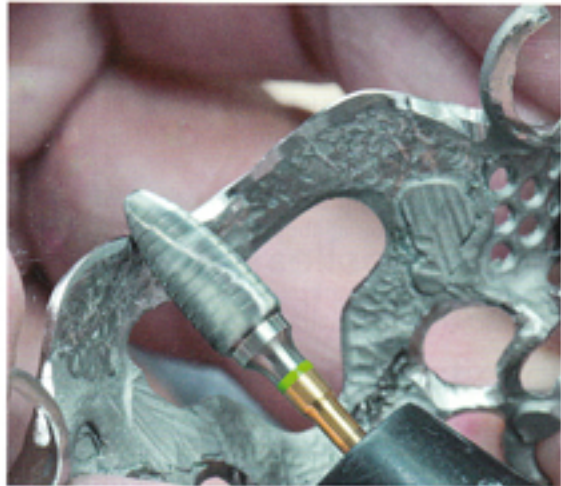
Abb. 2: Mit dem großen NEX-Fräser (H251) wird die dorsale Außenform bearbeitet.
