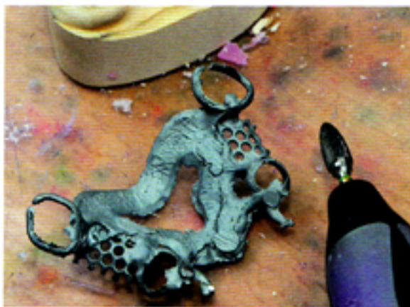
Abb. 1: Das Modellguss-Gerüst nach dem Guss. Wie kann auf effizientem Weg eine hochwertige Oberfläche erarbeitet werden?
