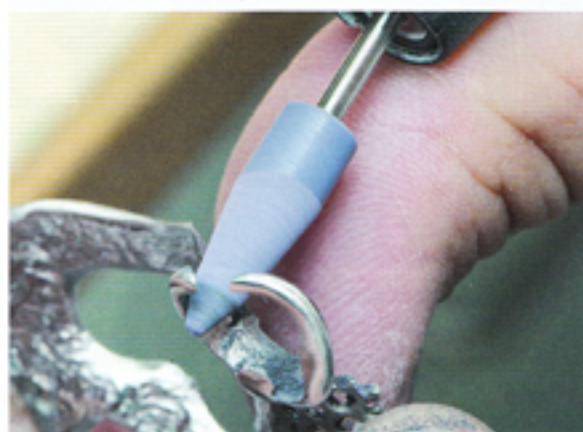
Abb. 7: Die NEM-Polierer von Komet bieten ein ideales Pendant zu den NEX-Fräsern. Es erfolgt die Vorpolitur.
