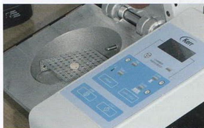
Abb. 28: Endvergütung bei Hitze, Druck und Schutzgas.
