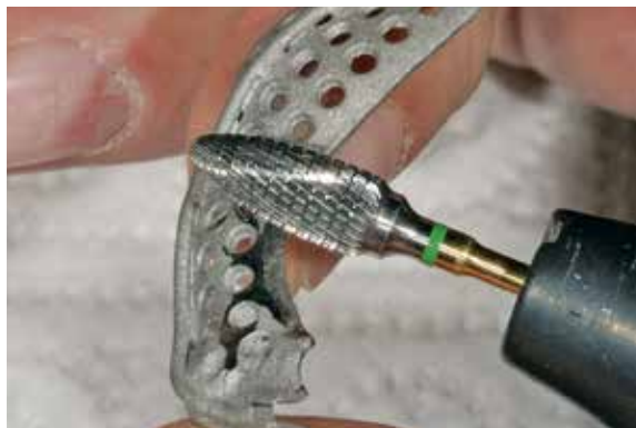
Abb. 58: Ausarbeiten des Modellgusses mit dem NEX-Hartmetallfräser.
