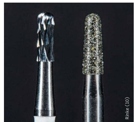
Abb. 9: Universell einsetzbare rotierende Instrumente für das Auftrennen metallkeramischer (links: H4MCL.314.012, Komet Dental, Lemgo) und vollkeramischer (rechts: 4ZRS.314.016, Komet Dental, Lemgo) Restaurationen
