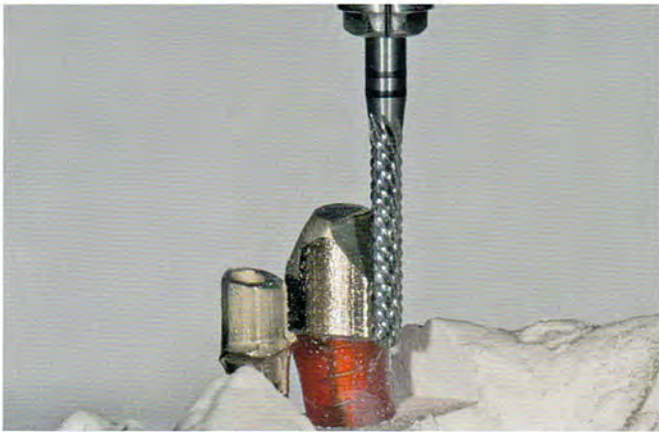
Abb. 45: Der Komet-Parallelfäser im Einsatz: Vorfräsen des Teleskops ...
