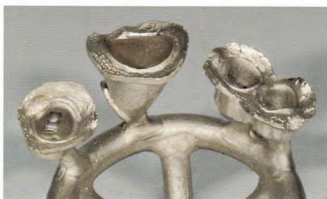
Abb. 64: Perfekter Guss mit TK-Snap-Kasten.
