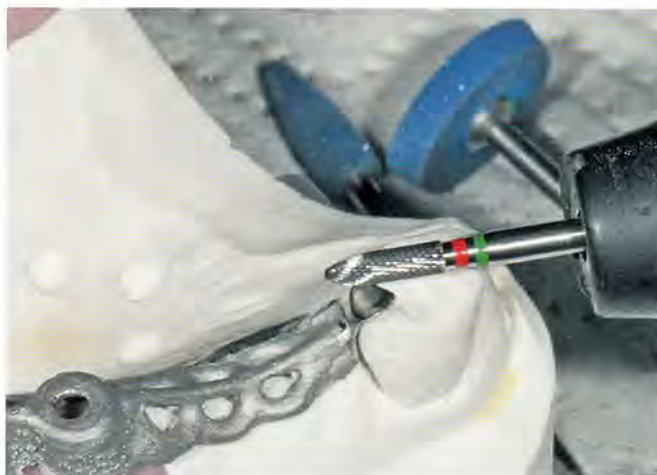
Abb. 79: Ausarbeiten der Auflage.
