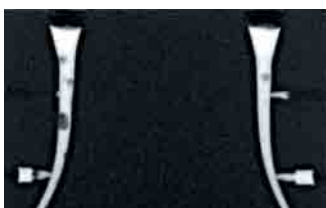
Tradycyjny uszczelniacz X (pęcherze powietrza) Commercially available sealer X (entrapped air)
