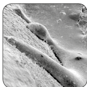
Przed: szczelina łączenia z nadmiarem cementu
