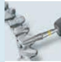
Komet die DF-Fräser entwickelt. Die feine Diamantverzahnung sorgt für optimale Oberflächenverhältnisse und begünstigt ein kontrolliertes Aufrauen. Ihre pyramidenförmig zulaufenden Schneidspitzen erzeugen zudem eine Flächenvergrößerung auf dem Metall, die wiederum den Haftverbund Metall-Keramik positiv beeinflusst.
